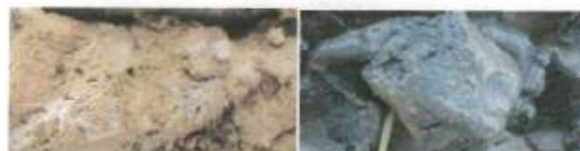
Photo 15 : Exemples de carotte avec des traces rédoxiques* (à gauche (taches ocre et grises) et un horizon réductique (à droite horizon bleu-gris humide)
